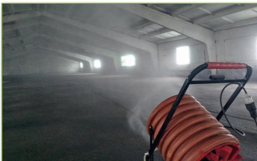
**Рисунок 2 – Аэрозольная обработка незагруженного зернохранилища с помощью генератора холодного тумана (фото ориг. И. Цветков)**
