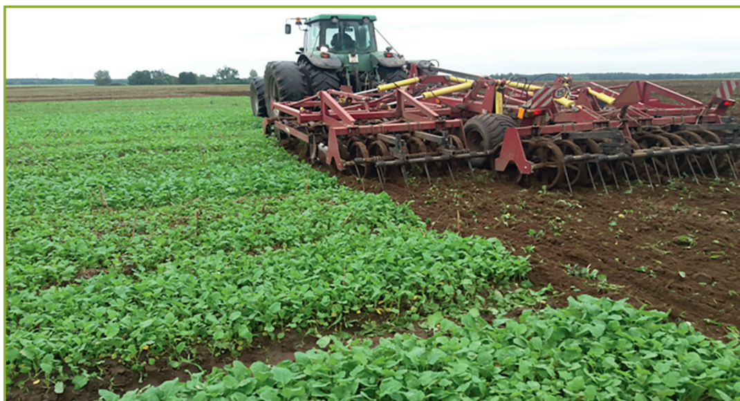
Рисунок 1 – Безотвальная разноглубинная обработка почвы агрегатом АПМ-6 (ПООО «Техмаш») по всходам падалицы рапса озимого
