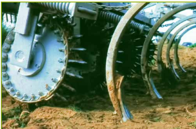
Расположение рабочих органов культиватора КГО
