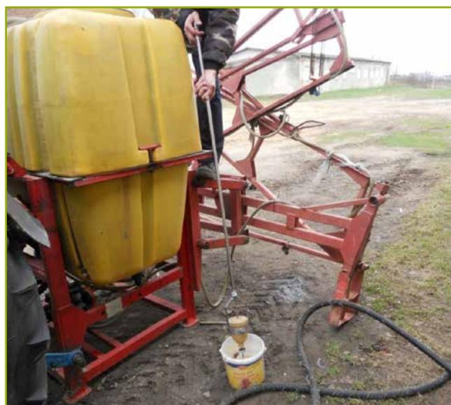
**Рисунок 3 – Фрагмент опорожнения стакана пробоотборника от рабочей жидкости**
