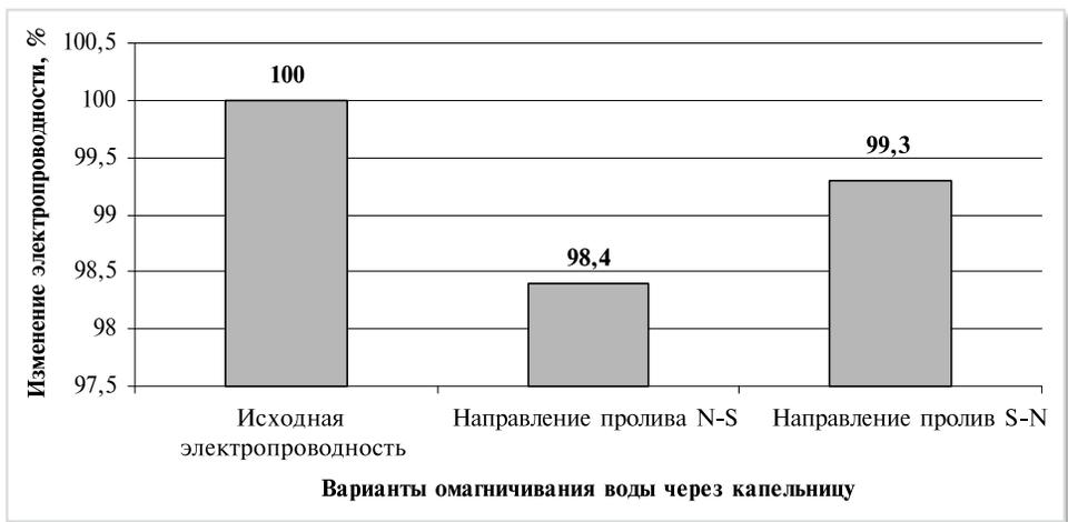
**Рисунок 5 – Изменение электропроводности воды после пропускания через капельницы с различными вариантами полярности магнитов**
