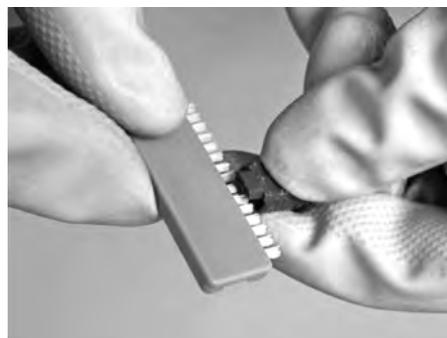
Рисунок 3 – Очистка распылителя специальной щеткой
